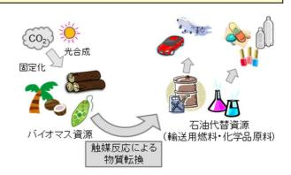
ことは困難であり、触媒化学プロセスによって利用しやすい形態に転換する必要があります。嶋田 研究室では石油精製の技術を応用し、バイオマス資源から輸送用燃料や化学品原料への転換を可能 とする安価かつ効率的なプロセスの開発に取り組んでいます。
