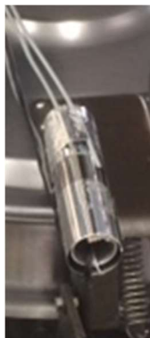
熱放射を遮っての気温計測
